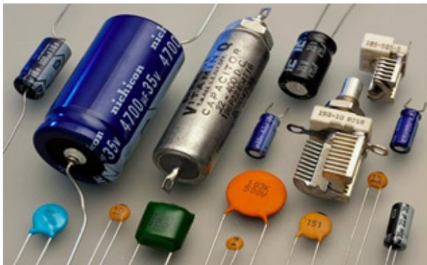
Um capacitor, de maneira simplificada, pode ser entendido como um par de condutores (placas) separados por um material isolante (dielétrico). Quando uma diferença de potencial (tensão) é aplicada a esse par de condutores, um campo elétrico é gerado no dielétrico. Esse campo é capaz de armazenar energia, de onde vem o nome “condensador” para esse componente.
