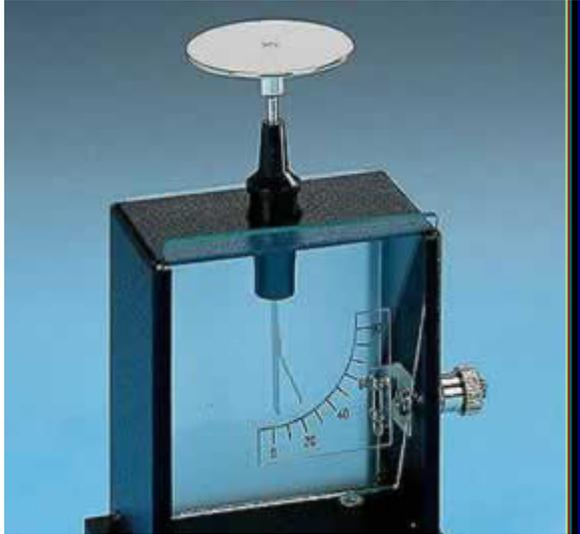
Segundo o estudo dos processos de eletrização, a indução ocorre quando se tem um corpo que está inicialmente eletrizado e é colocado próximo a um corpo neutro. Com isso, a configuração das cargas do corpo neutro se modifica de forma que as cargas de sinal contrário a do bastão tendem a se aproximar do mesmo.
