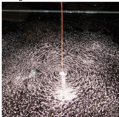
O sentido dessas linhas de campo geradas ao redor do fio pode ser determinado através de uma regra prática, chamada de **regra da mão direita**, em que o polegar aponta no sentido convencional da corrente elétrica e os demais dedos envolvem o condutor, revelando a orientação das linhas de campo magnético, como mostra a figura abaixo.
